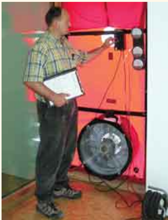
Messung der Luftdichtheit mit dem „Blower-Door-Test“
